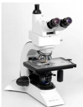
Профессиональный, бинокулярный исследовательский микроскоп с инновационной оптикой ICO Infinite (оптика скорректированная на «бесконечность»). Широкий спектр дополнительных опций позволяет производить фазово-контрастную, темнопольную (ультрамикроскопия), люминесцентную, поляризационную, ультрафиолетовую микроскопию. Кроме того, фото/видео порт для бинокулярной головки ERGO позволяют применять в исследованиях цифровые технологии, что облегчает сбор, анализ, хранение и передачу полученных данных.
