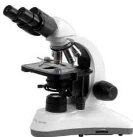
Специализированный бинокулярный поляризационный микроскоп для медицины, биологии и промышленности. Предназначен для исследования взаимодействия образцов с поляризованным светом, что позволяет выявить структуру объекта лежащую за пределами обычных оптических разрешений. Комплектуется набором поляризационных пластин.
