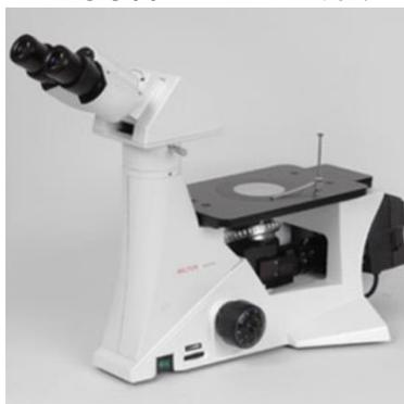
Специализированный металлографический инвертированный микроскоп. Схема инвертированного микроскопа удобна для наблюдения в отражённом свете структур различных поверхностей, поэтому она применяется в большинстве металлографических исследованиях. В микроскопах данной серии можно использовать метод светлого поля при прямом и косом освещении, наблюдение в поляризованном свете.
