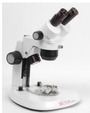
Бинокулярный стереомикроскоп с переменным фокусным объективом для промышленного использования. Функция Zoom (объектив с переменным фокусом) облегчает и упрощает работу с данным микроскопом. Стереоскопическое восприятие облегчает манипуляции с микрообъектами в ходе наблюдения и широко используется при биологических исследованиях, в микрохирургии, при сборке миниатюрных устройств.
