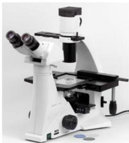
Специализированный инвертированный микроскоп. Преимуществом инвертированного микроскопа является то, что толщина исследуемого образца не ограничена рабочим расстоянием объектива, то есть можно использовать специальную посуду (чашки Петри, планшеты или специальные кюветы).
