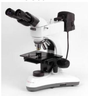
Металлографический бинокулярный микроскоп. Использование новых объективов (МЕТ ICO PLAN), а так оптики скорректированной на «бесконечность», позволяют производить более точные и информативные исследование в области металлографии (макро – , микроанализ, изучение микроструктуры различных сплавов). Используются в научных и промышленных лабораториях.
