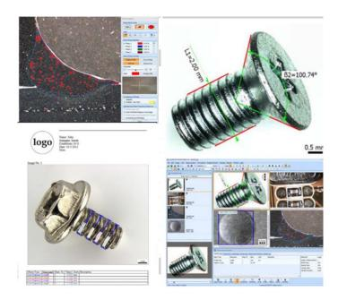
Программа предназначена для использования в промышленных областях и научных приложениях. Она оснащена многими измерительными функциями: измерение длины, периметра, площади, угла, расстояния между параллельными линиями, подсчета объектов, фазового анализа, измерения твердости и микротвердости и оснащена передовыми функциями экспорта данных и отчетности.
